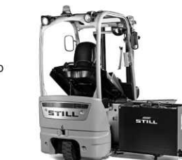
4) Plataforma com roletes, integrada para a troca com o uso de talha.
