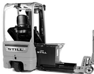
3) Troca realizada com o uso do estrado para troca de baterias acoplada a uma transpaleteira manual.
