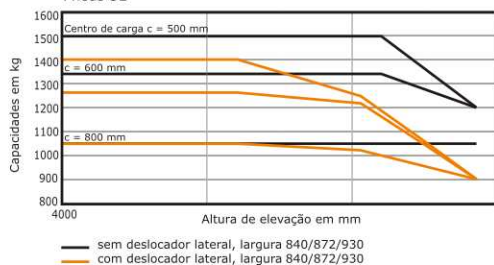
Capacidades de carga básicas RX 50-15 Mastro Tele/HiLo Pneus SE
